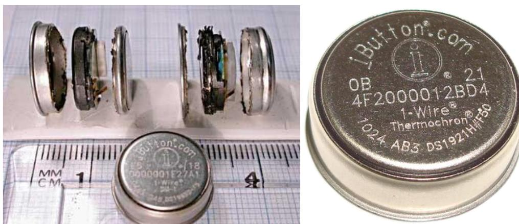
Рис.2. Внутреннее устройство «ТЕРМОХРОН» и его внешний вид
