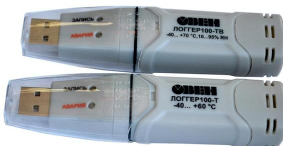
Рис.4. Устройство «Логгер100»
